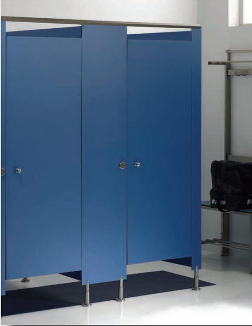
Las Cabinas Istria miden 2.000mm de altura y se apoyan en el suelo mediante patas regulables de acero inoxidable o material plástico de color negro. El resto de herramientas se suministran en acero inoxidable. El cuerpo de la cabina consiste en un laminado de alta presión de doble cara decorativa, fabricado a base de resinas fenólicas reforzado con fibras de celulosa. Todas las aristas están redondeadas.
